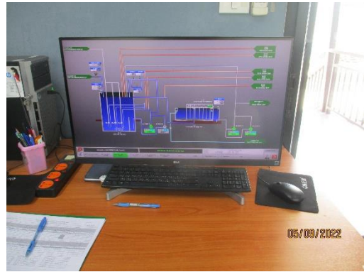
รูปที่ 3 การติดตั้งระบบ SCADA
